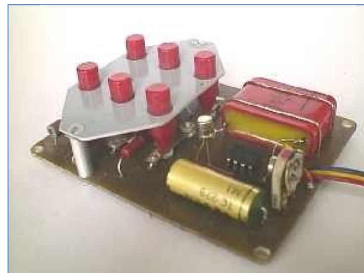
Šestirychlostní TUNIT 1980. Použit byl N-FET KF521 a operační zesilovač LM741. Kondenzátor byl REMIX C213, 4 \mu F, 63 V. Měřidlo mělo být v transceiveru, který však nebyl nikdy dokončen
