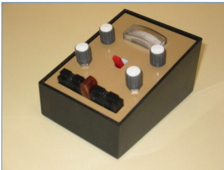
Hotový TUNIT 2002 v krabičce, s čelním panelem. Na panelu je analogové měřidlo, pod ním přepínač AUT-MAN, dole čtyři tlačítka ručního ladění. Mezi tlačítky je zaoblená přepážka pro snadné rozlišení tlačítek hmatem. Dva horní knoflíky jsou přepínače rychlostí automatického přeladování v obou směrech, dva spodní knoflíky nastavují horní a spodní rozsah ladění
